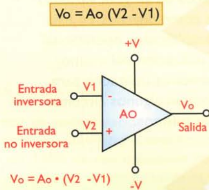
Figura 9.1. Símbolo de un amplificador operacional.
